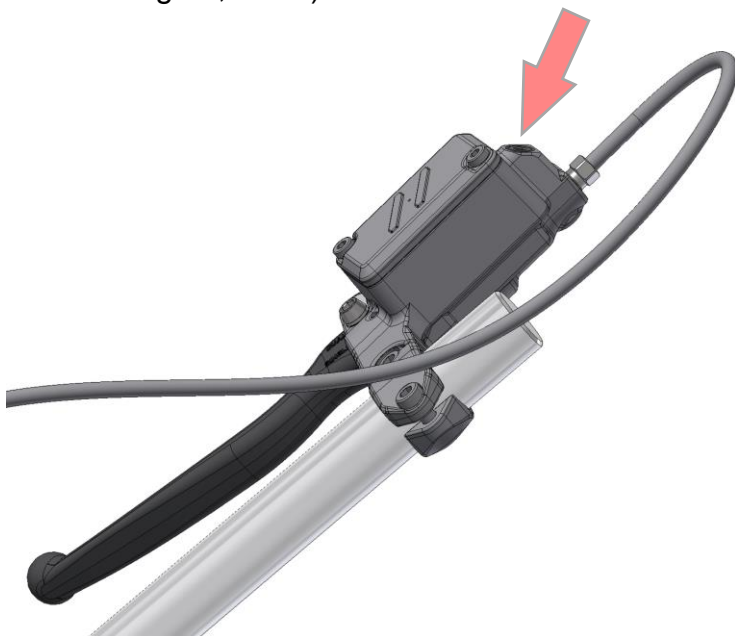
Abbildung 19 - Ausrichtung Bremsarmatur, Entlüftungsschraube oben
