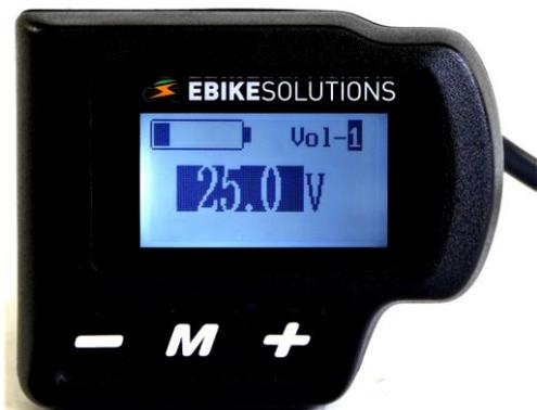
Haben Sie den passenden Spannungswert gewählt (möglich sind Spannungswerte zwischen 20,0 V und 60,0 V), drücken Sie kurz **MODE** zur Bestätigung:
