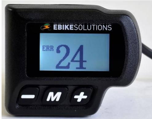
Das Display kehrt erst wieder in den Normalzustand zurück, wenn die Störung behoben wurde. Bis dahin darf das System nicht mehr verwendet werden. Wenn Sie den Fehler nicht selbst beheben können, wenden Sie sich bitte an unseren Kundenservice. Die Kontaktinformationen finden Sie am Ende dieser Bedienungsanleitung. Versuchen Sie nicht, den Umrüstsatz oder seine Bestandteile zu öffnen oder unsachgemäß zu manipulieren.
