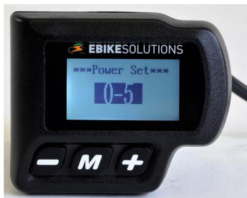
Neben 3, 5, 7 oder 9 Unterstützungsstufen können Sie auswählen, ob zusätzlich die Stufe „0“ zur Verfügung stehen soll oder nicht. In Stufe „0“ werden zwar Daten auf dem Display angezeigt, es erfolgt aber keine Unterstützung durch den PAS-Sensor, wenn Sie treten.
