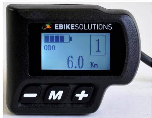
**Tipp:** „ODO“ wird nur im Stillstand angezeigt. Sowie Sie losfahren, kann „ODO“ über die Taste **MODE** nicht mehr aufgerufen werden.
