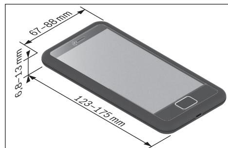
As dimensões especificadas são com a capa. Smartphones com **capa tipo estojo ou com tampa** não podem ser colocados.
