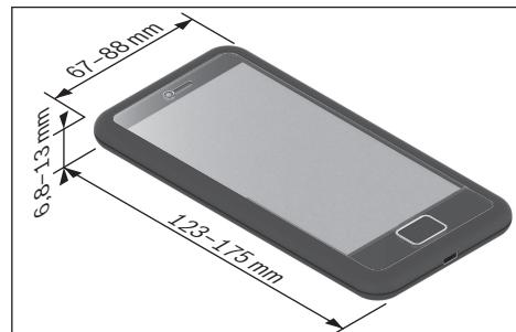
Les dimensions indiquées incluent la coque. Il n'est pas possible d'insérer dans le SmartphoneGrip des smartphones avec **housse ou étui à rabat**.
