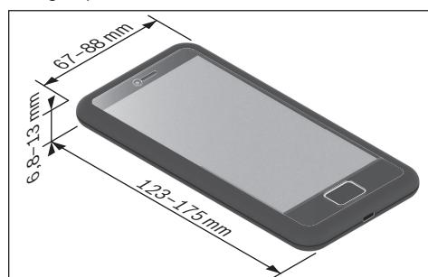
De aangegeven afmetingen zijn inclusief hoesje. Smartphones met **klap- en etuihoesjes** mogen niet worden bevestigd. Het totale gewicht mag niet hoger zijn dan 276 g.
